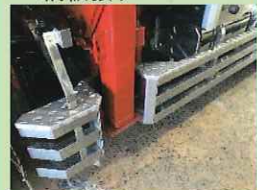
【サイドガード 滑り止め工作】 縞板張り
