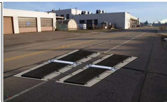
図45 路面設置型測定器の運用イメージ
