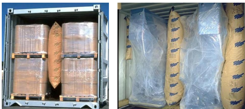
ダンナージ用エアバックを使用した貨物の固定
