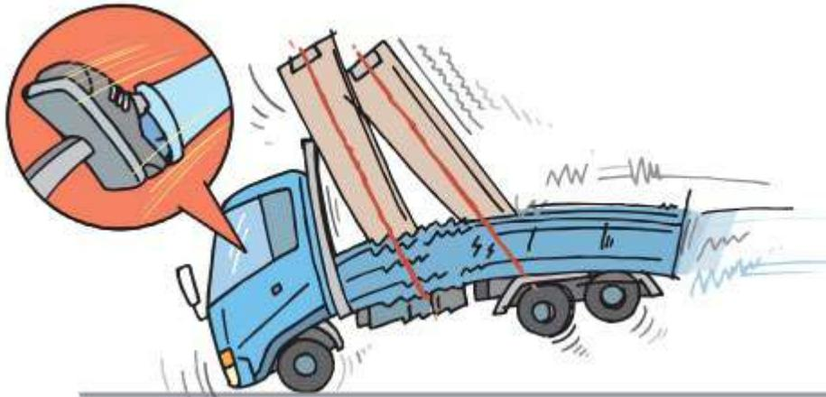
図5 トラックに積載した貨物が走行中に受ける力の大きさ
